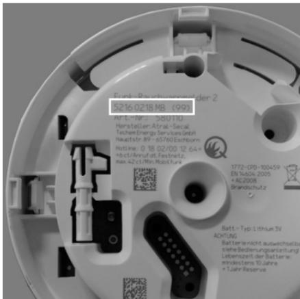
**5** Приставьте прибор к монтажной пластине, слегка вращая его против часовой стрелки, и заверните прибор, не прилагая не прилагая особых усилий, в направлении по часовой стрелке до щелчка.
