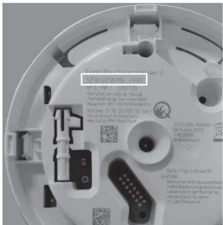
**5** Stecken Sie das Gerät mit einer leichten Drehung gegen den Uhrzeigersinn auf die Montageplatte und drehen Sie es ohne übermäßigen Kraftaufwand im Uhrzeigersinn, bis es einrastet.
